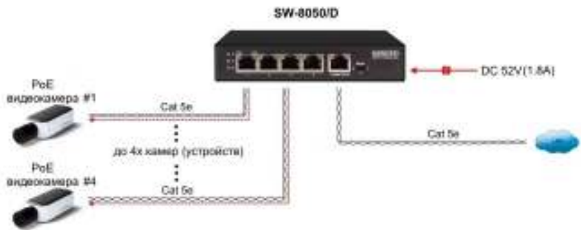
Рис.5 Схема подключения коммутатора SW-8050/D в режиме PoE инжектора
