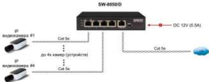
Рис.6 Схема подключения коммутатора SW-8050/D (без использования PoE)
