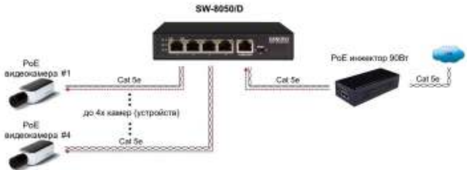
Рис.4 Типовая схема подключения коммутатора SW-8050/D в режиме питания от PoE инжектора
