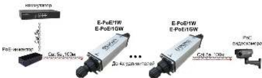
Рис. 7 Схема подключения удлинителей на примере модели E-PoE/1W, E-PoE/1GW
