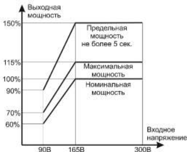
График 1 – Зависимость выходной мощности от входного напряжения сети переменного тока
