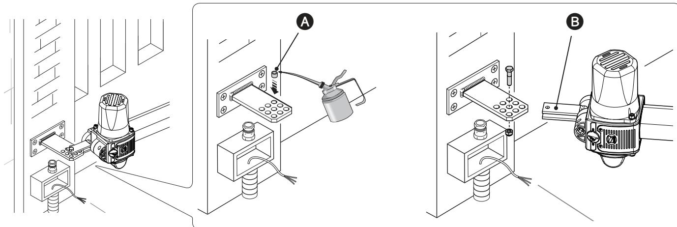
Откройте створку, вставьте наконечник в отверстие переднего кронштейна и зафиксируйте его с помощью шайбы и гайки.
