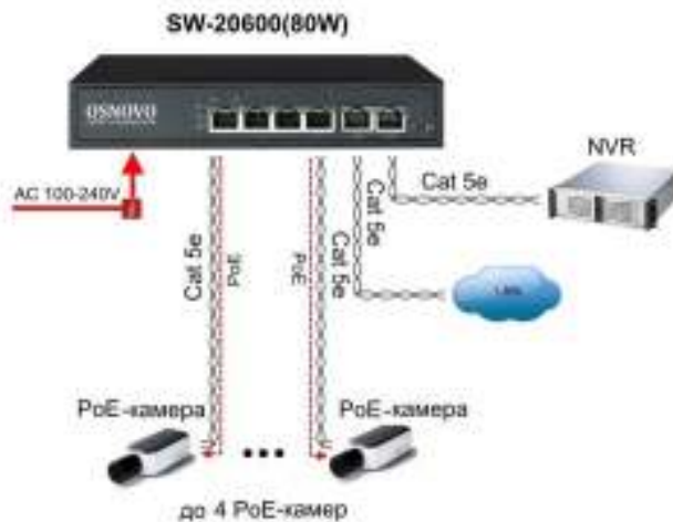
Рис.4 Типовая схема подключения коммутатора SW-20600(80W)
