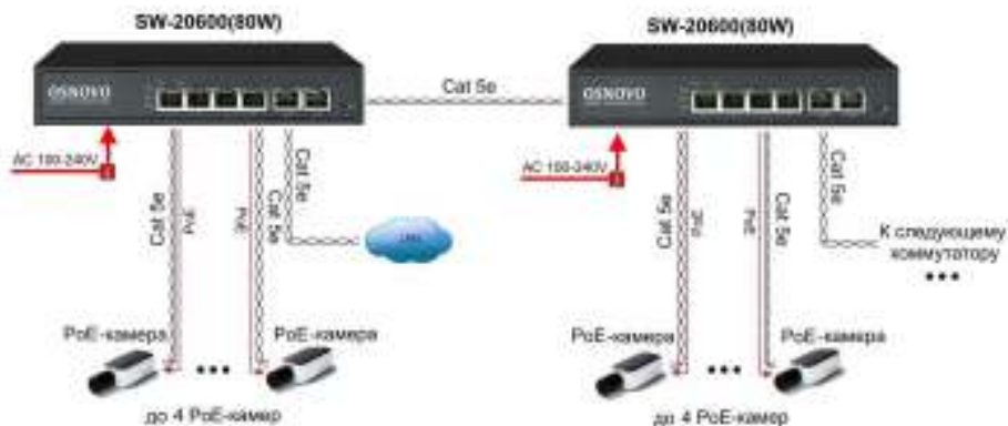
Рис.5 Схема подключения нескольких коммутаторов SW-20600(80W)
