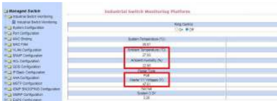
Рис.7 Контроль температуры/влажности, напряжения питания через WEB-интерфейс коммутатора
