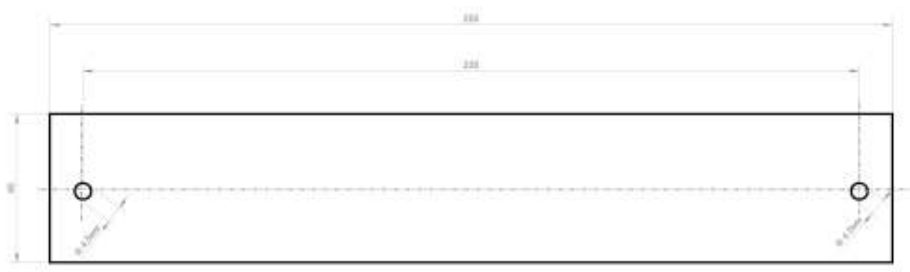
Рис. 3.5-2 Шаблон для сверления отверстий для крепления полки саморезами.
