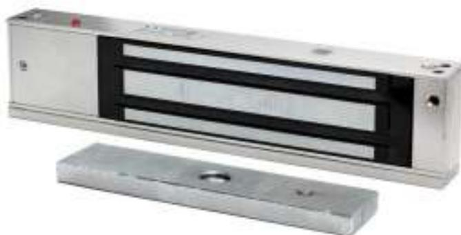
Электромагнитный замок ST-EL360L предназначен для запираения дверей, контролируемых СКУД, а также дверей эвакуационных выходов. Одноцветная световая индикация обеспечивает визуализацию различных состояний замка: СИД не горит – нет питания, красный сигнал – на замок подано питание. Для преодоления остаточной намагниченности в устройстве используется специальное цинковое покрытие якоря замка совместно с пружинным механизмом.
