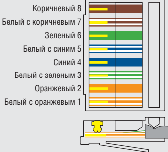
Рисунок 6. Обжимка кабеля UTP
