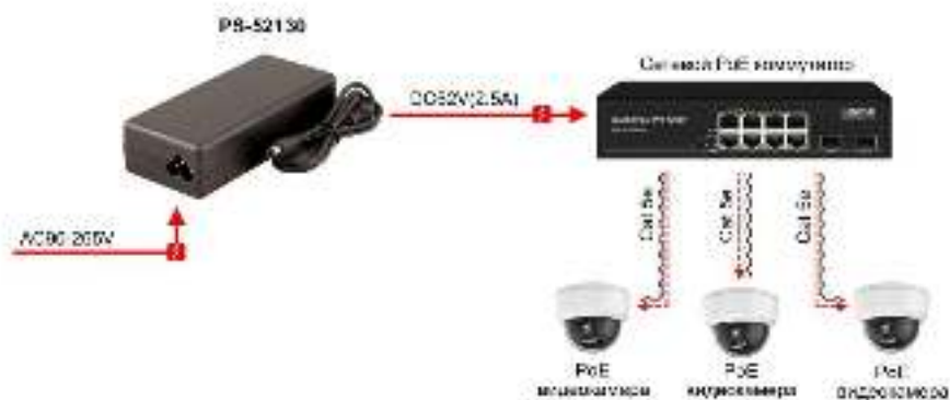
Рис.4 Типовая схема подключения блока питания PS-52130
