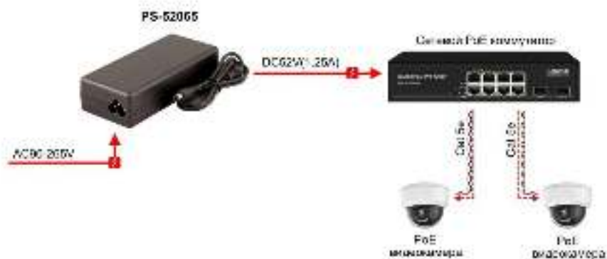
Рис.3 Типовая схема подключения блока питания PS-52065
