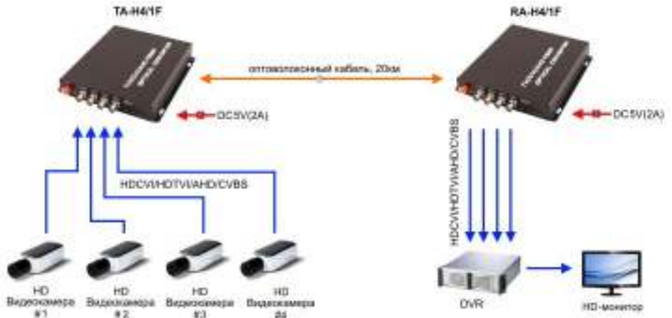
Рис.12 Типовая схема подключения передатчика и приемника на примере TA-H4/1F, RA-H4/1F
