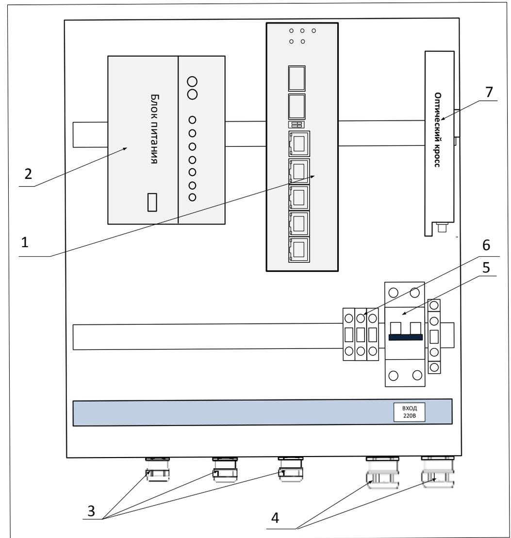
Рис. 2. Базовая комплектация Узла доступа NSBox-245-H\*
