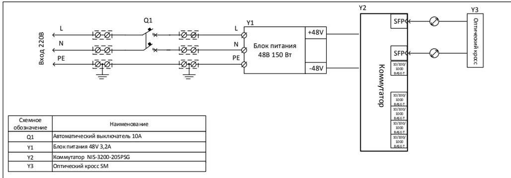
Рис. 1. Электрическая схема Узла доступа NSBox-245-H
