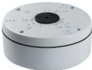
Монтажная коробка для видеокамеры Optimus предназначена для выполнения монтажа видеокамер OPTIMUS серии IP-P Starvis на вертикальной или горизонтальной поверхности внутри помещений или на улице, а также для надежной коммутации подводящих проводов с защитой от механических повреждений и степенью защиты IP66.
