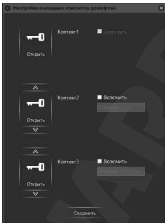
Рис. 5.5. Окно настройки выходных контактов видеодомофона
