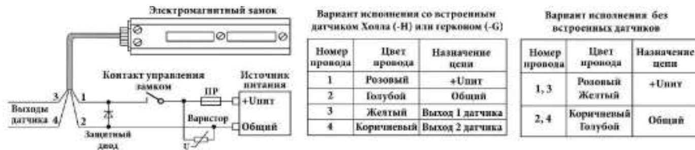
Рисунок 9 - Схема подключения замка
