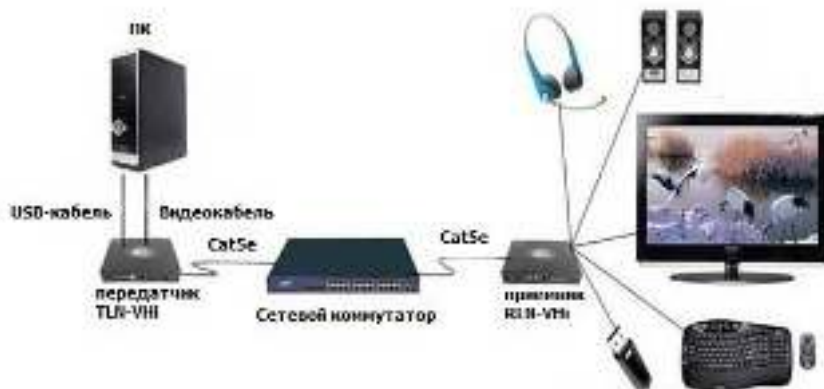
Рис.4 Схема подключения передатчика TLN-VHi и приемника RLN-VHi с помощью сетевого коммутатора.
