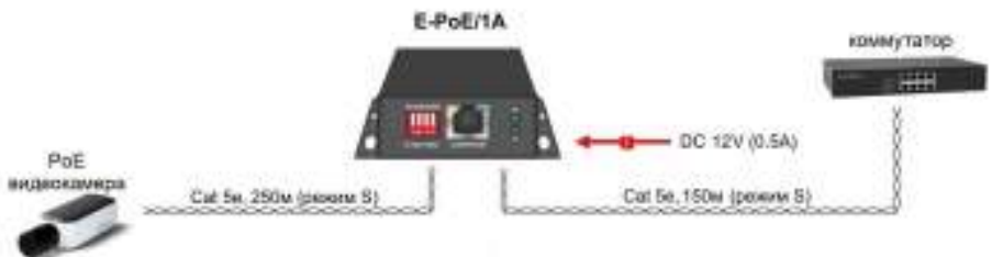
Рис.6 Схема подключения удлинителя E-PoE/1A в режиме удлинения Ethernet
