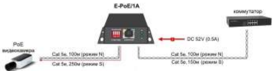
Рис.5 Схема подключения удлинителя E-PoE/1A в режиме PoE инжектора
