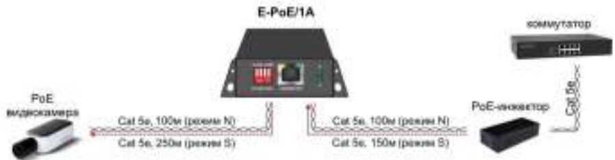
Рис.4 Типовая схема подключения удлинителя E-PoE/1A в режиме питания от PoE инжектора
