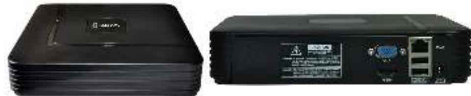
На задней панели регистратора расположен разъем питания, 2 разъема USB, разъем RJ45, VGA, HDMI.
