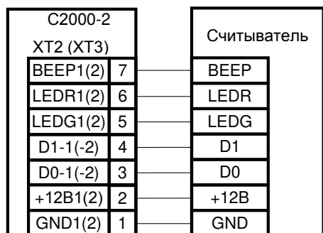
Рисунок 12. Схема подключения считывателей с интерфейсом Wiegand или ABA Track-II
