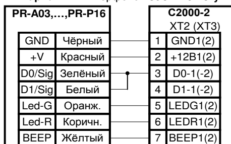
Рисунок 14. Схема подключения считывателей Proxy-2A исп.01, Proxy-2M, Proxy-2MA, Proxy-3A, Proxy-3M, Proxy-3MA
