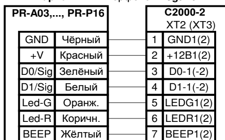
Рисунок 14. Схема подключения считывателей Proxy-2A исп.01, Proxy-2M, Proxy-2MA, Proxy-3A, Proxy-3M, Proxy-3MA
