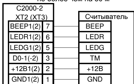
Рисунок 11. Схема подключения считывателей с интерфейсом Touch Memory
