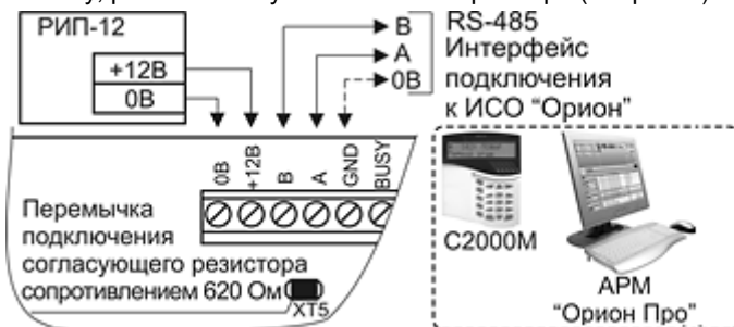
Рисунок 4. Схема подключения по интерфейсу RS-485
