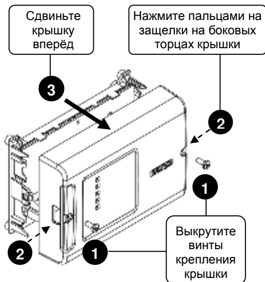
Рисунок 2. Снятие крышки контроллера
