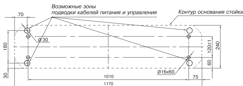
Схема разметки отверстий
