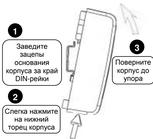
Рисунок 3. Крепление блока на DIN-рейку
