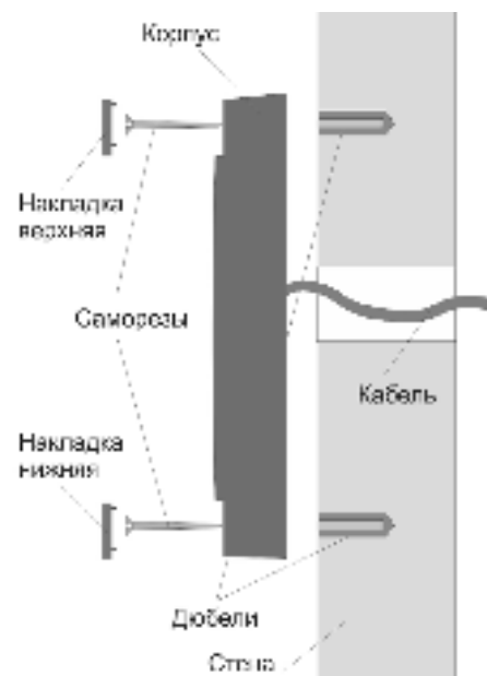
Рисунок 4. Крепление считывателя PNR-EH19
