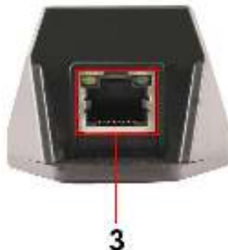
Рис. 3 Конвертер методов PoE CN-PoE/G, индикаторы
