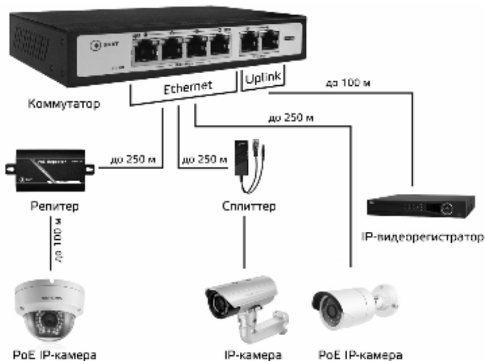
Рисунок 7 – общая схема подключения устройств к коммутатору
