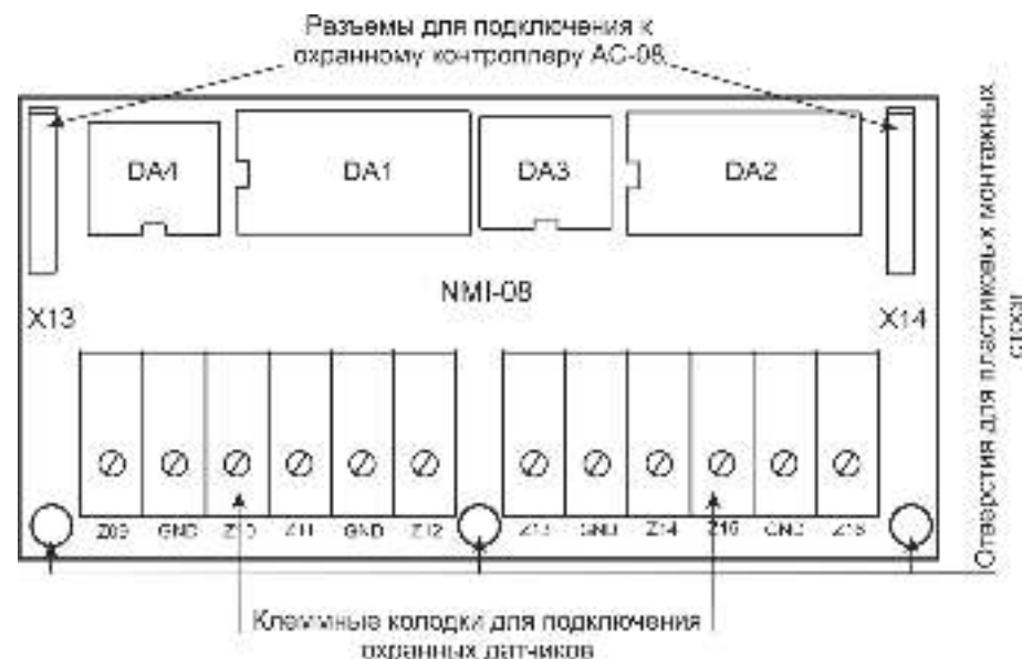
Рисунок 1. Схема платы зонного расширителя NMI-08
