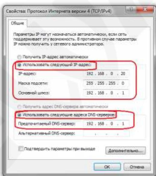
Запомните, либо запишите конфигурацию сетевых настроек адаптера Вашего ПК (IP-адрес, Мaska подсети, Сетевой шлюз, DNS-сервер).
