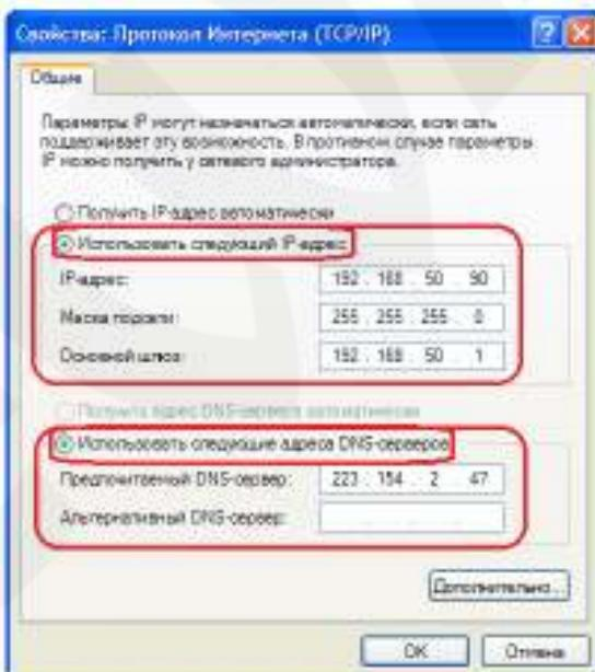
Запомните либо запишите конфигурацию сетевых настроек адаптера Вашего ПК (IP-адрес, Маска подсети, Сетевой шлюз, DNS-сервер).
