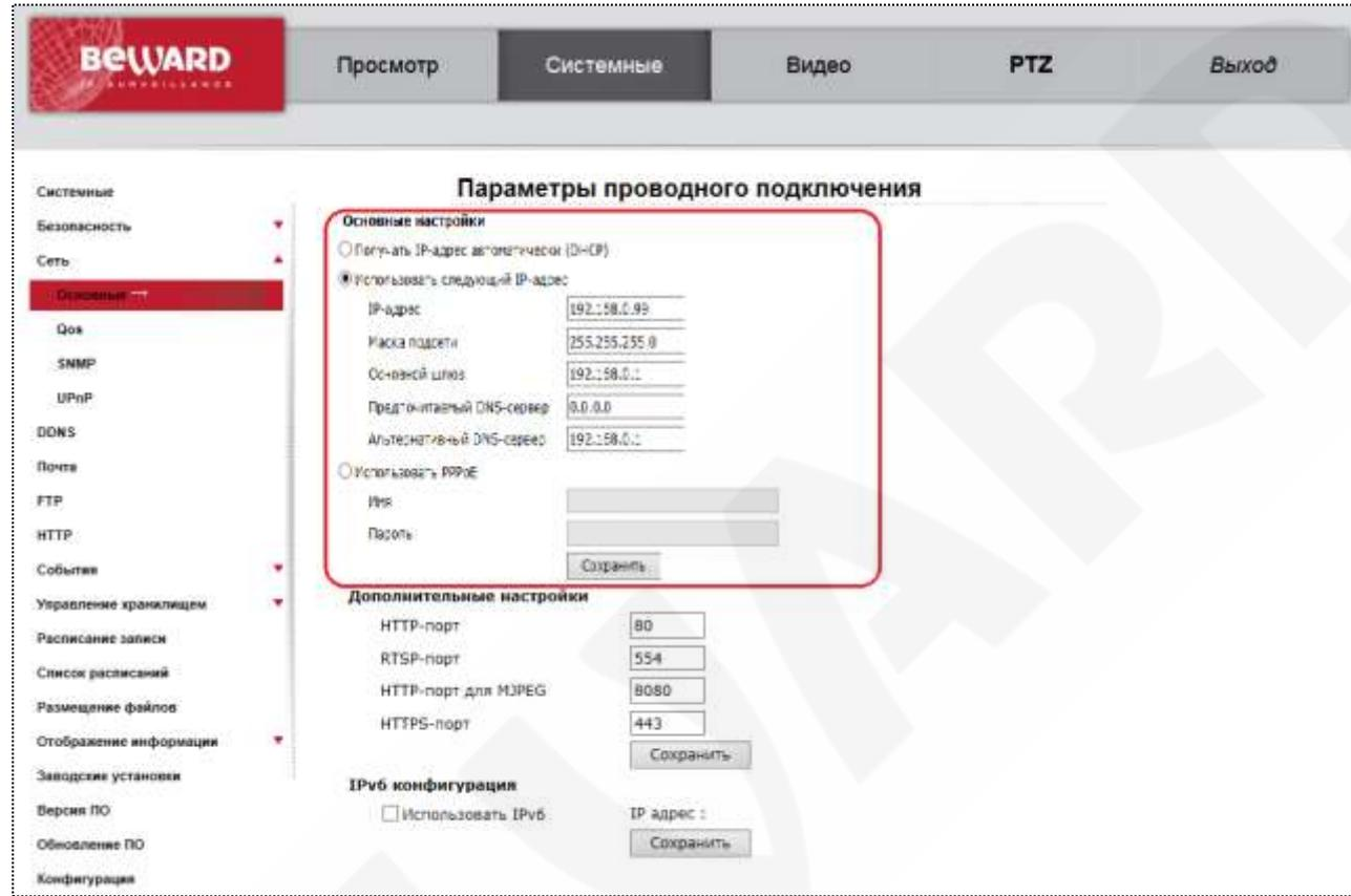
**Получить IP-адрес автоматически (DHCP) (Get IP address automatically):** устанавливает автоматическое получение основных сетевых параметров от DHCP-сервера. Для работы этой функции необходимо наличие в сети DHCP-сервера.
