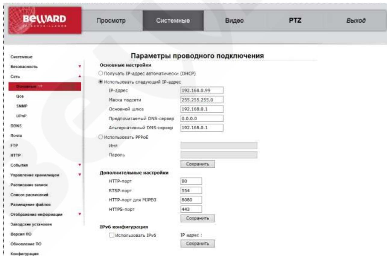
Меню условно можно разделить на три части: [Основные настройки (General)], [Дополнительные настройки (Advanced)], [IPv6 конфигурирование (IPv6 address Configuration)].
