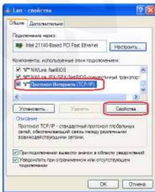
Откроется окно, в котором отображается информация о настройках сетевого подключения. Возможны два варианта настройки IP-адреса сетевого подключения Вашего ПК:
