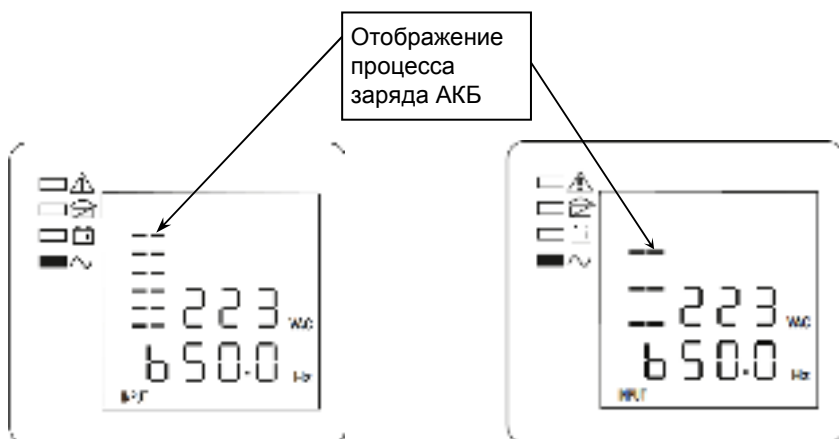
Рисунок 21 — ЖК-дисплей, форсированный (ускоренный) заряд АКБ
