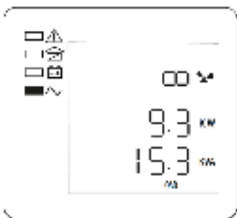
Рисунок 17 — ЖК-дисплей, общая мощность нагрузки
