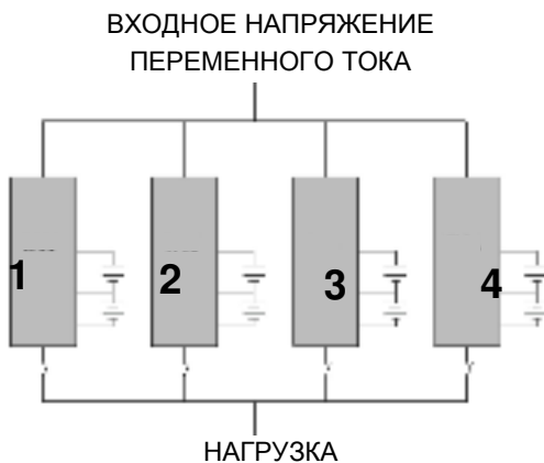
Рисунок 24 — Схема подключения изделий в систему параллельного резервирования.
