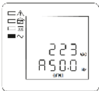
Рисунок 11 — ЖК-дисплей, Фаза А, выходное напряжение и частота
