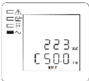
Рисунок 13 — ЖК-дисплей, Фаза С, выходное напряжение и частота
