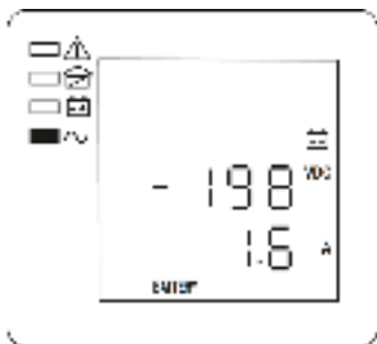
Рисунок 9 — ЖК-дисплей, отрицательная группа АКБ, напряжение и ток
