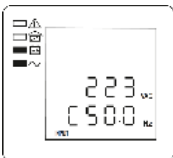
Рисунок 7 — ЖК-дисплей, Фаза С, входное напряжение и частота
