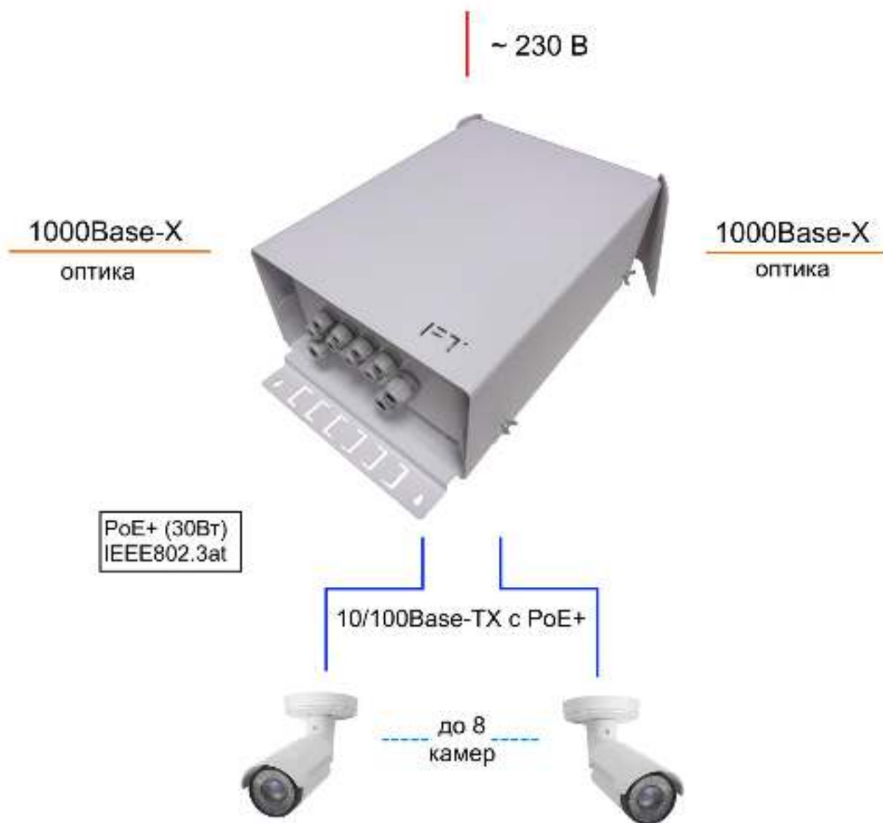
Схема подключения PSW-2G8F+Hot (8 камер)
