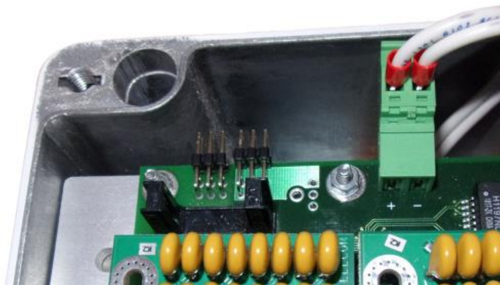
Рисунок 3.5.1 - Датчика вскрытия на плате
