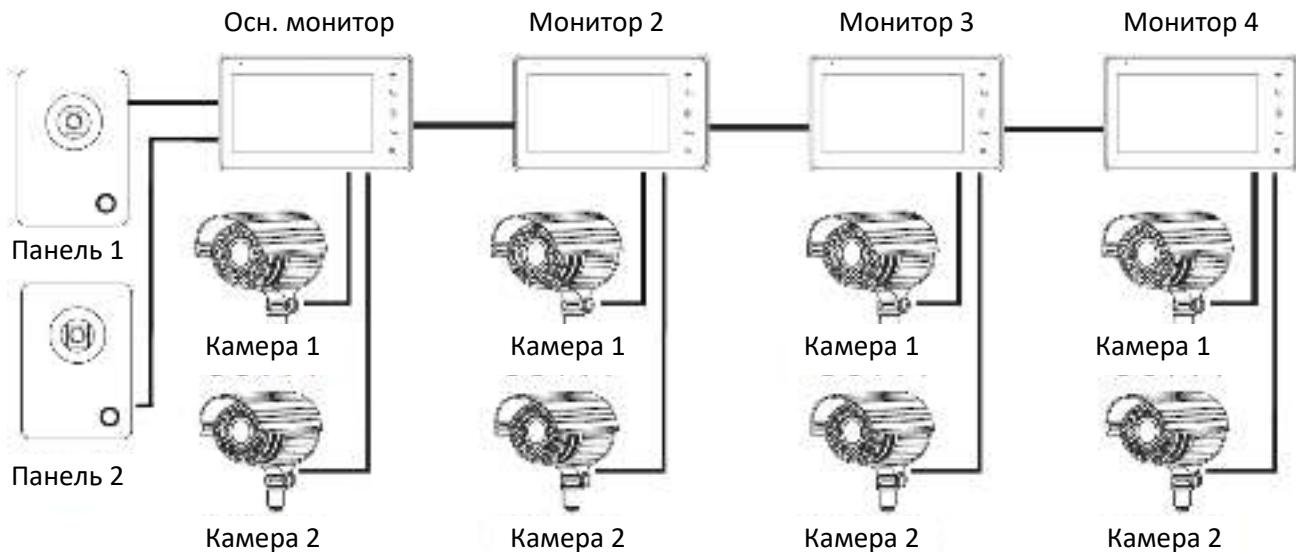
Максимальная конфигурация системы: один основной монитор, три дополнительных монитора, две вызывные панели, 8 дополнительных видеокамер.
