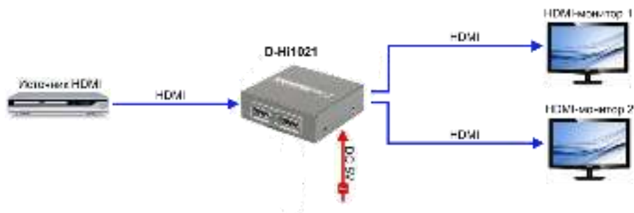
Рис.4 Типовая схема подключения HDMI разветвителя D-Hi1021
