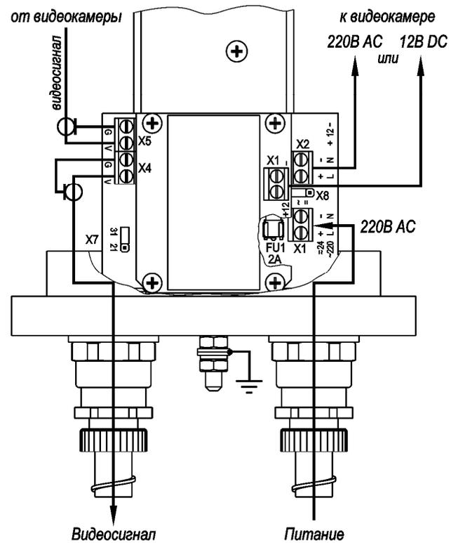
Рис.3 Подключение ТГБ-4Г- ~220/12(~220)
