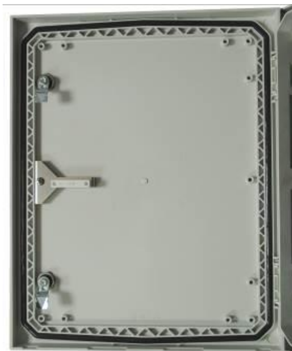
Рисунок 3.7.1 - Датчик вскрытия на крышке коммутатора
