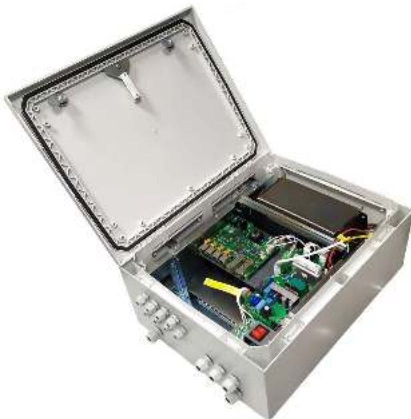
Рисунок 3.1.2 - PSW-2G+UPS-Box - вид внутри
