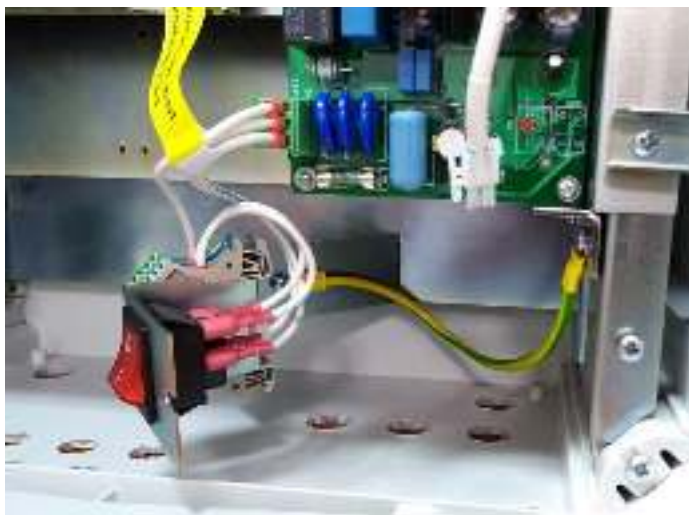
Рисунок 3.5.2 – Узел подключения питания освобожден от крепежа.
