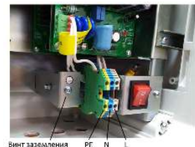
Рисунок 3.5.1 – Узел подключения питания.
