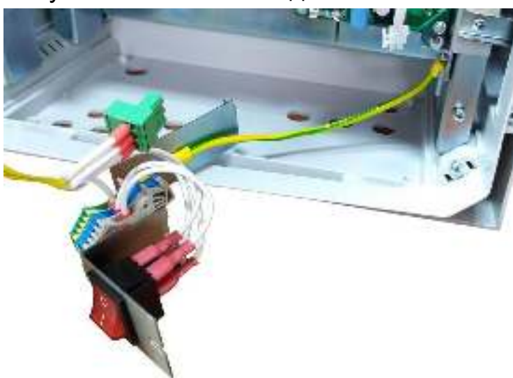
Рисунок 3.5.3 – Разъем питания 230 В отключен.
