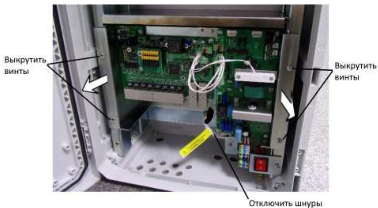
Рис. 7.1.2. Извлечение электронного узла
