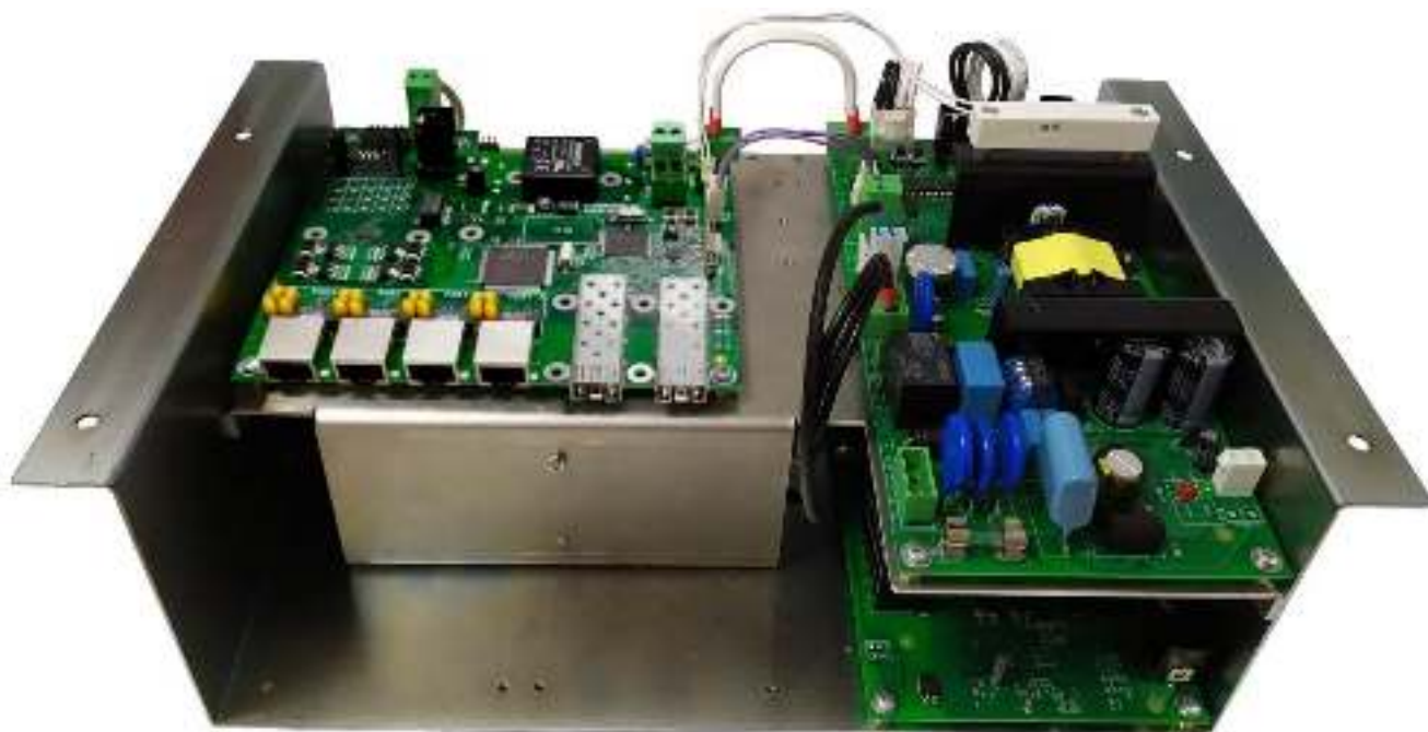
Рисунок 3.4.1 - Платы коммутатора и блоков питания
