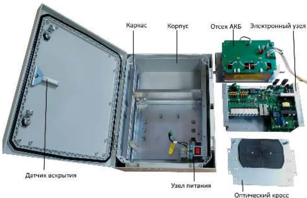
Рисунок 3.1.3 – Основные элементы коммутатора
