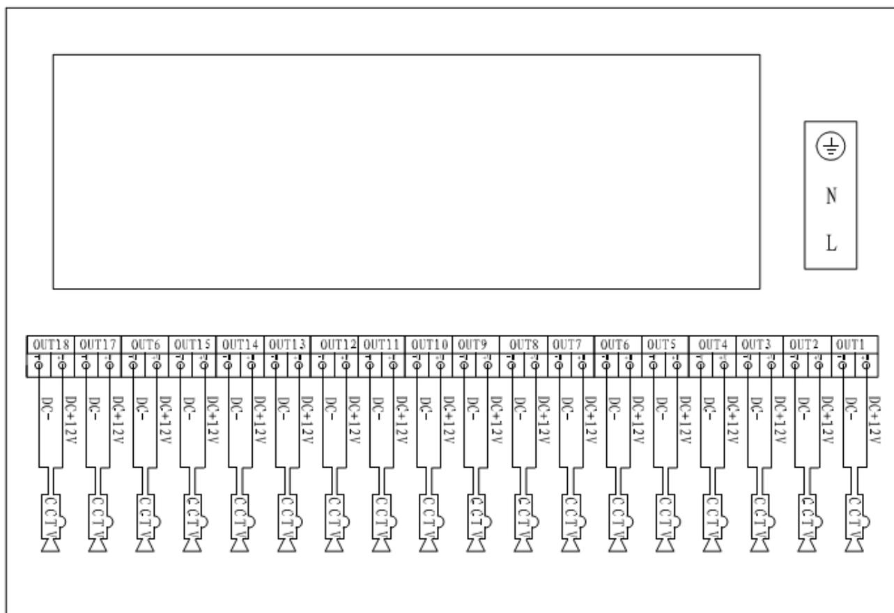
**Внимание!** Несоблюдение полярности подключения может привести к выходу из строя подключаемых устройств.
