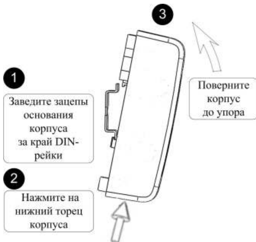
Рисунок 2.2.3 – Схема установки блока на DIN рейку.
