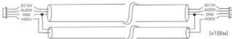
3. Сетевой кабель CAT5 или CAT6 (**НЕ РЕКОМЕНДУЕТСЯ ДЛЯ ИСПОЛЬЗОВАНИЯ!**). В случае использования неэкранированного кабель длина линии не должна превышать 20м. При использовании экранированного кабеля длина линии может быть увеличена до 40м.
