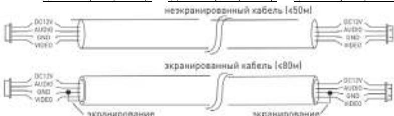
В случае использования неэкранированного кабеля длина линии не должна превышать 50м. При использовании экранированного кабеля длина линии может быть увеличена до 80м.
