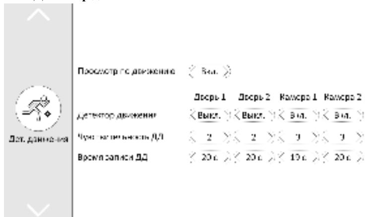
Раздел детектора движения позволяет настроить любой из четырех каналов на включение записи и мониторинга по обнаружению движения перед вызывной панелью или камерой.
