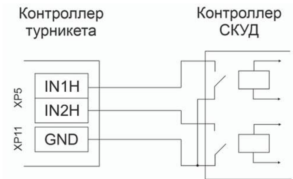
Рисунок 8.2.2 Схема подключения турникета к СКУД «сухой контакт»
