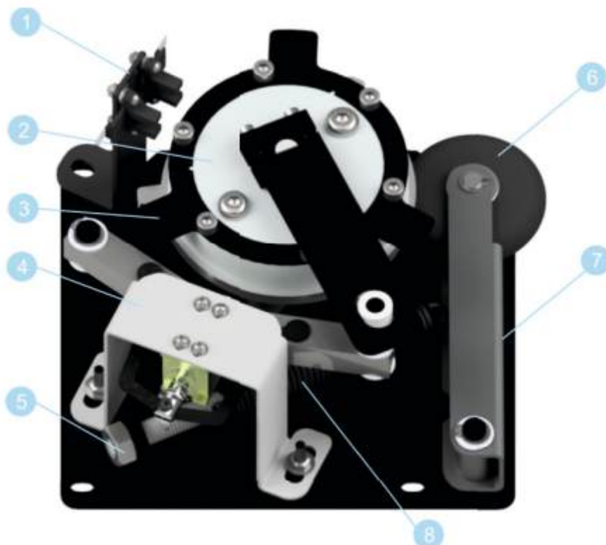
Рис. 6.2.1 - Устройство механизма турникета
