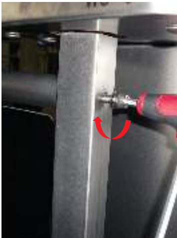
2. Затяните верхний винт
