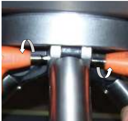
3. Затяните винты (шестигранник 5 мм)
