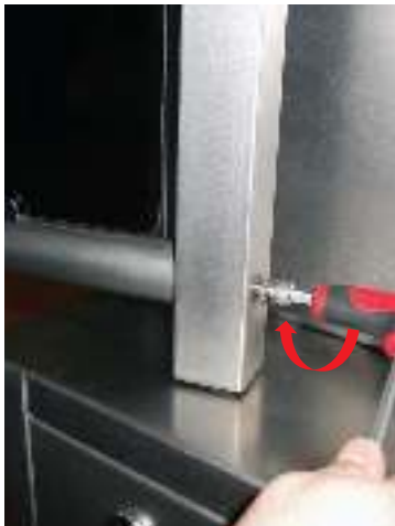
3. Затяните нижний винт
