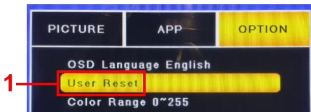
Рис. 13 Сброс настроек ЖК – панели.
