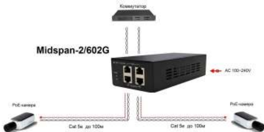
Рис.4 Схема подключения инжектора Midspan-2/602G
