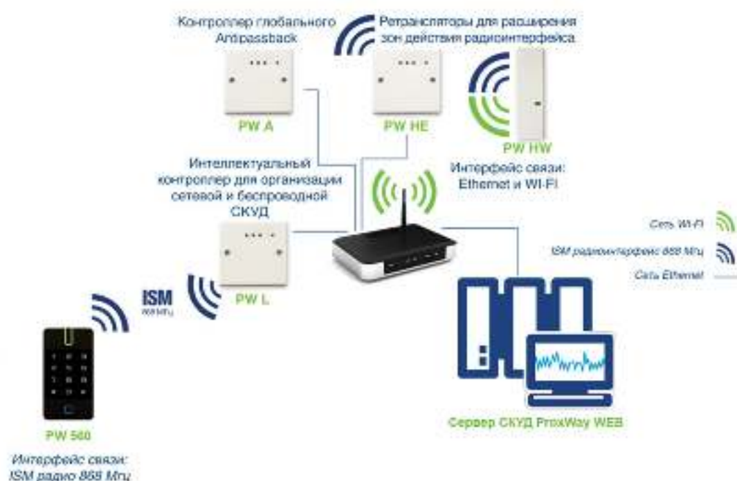
Топология беспроводной сетевой СКУД
