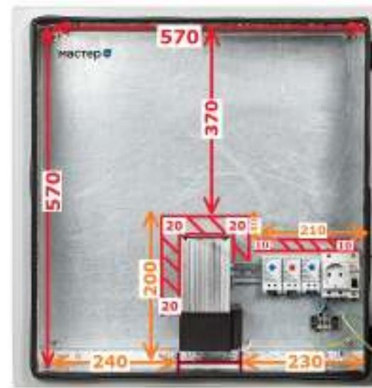
**Внимание!** Температура корпуса обогревателя во время работы превышает 70°C, во избежание повреждения аппаратуры и кабелей производите их монтаж на расстоянии не менее 20 мм от обогревателя.
