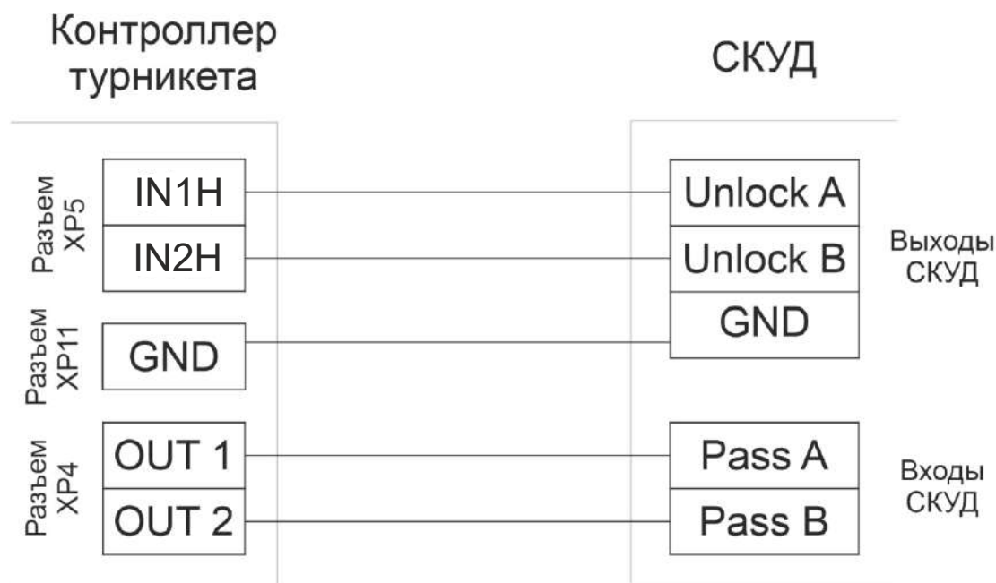
Рисунок 8.2.1 Подключение турникета к стороннему СКУД
