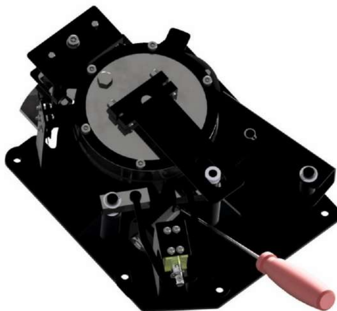
Рисунок 12.4.1 - Регулировка натяжения пружины доводчика
