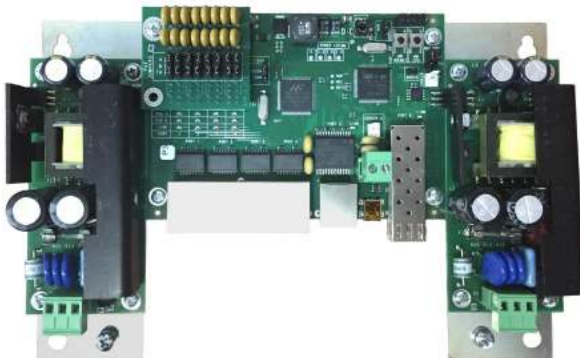
Рисунок 3.4.1 - Плата коммутатора и блоков питания
