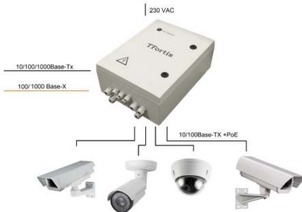
Рисунок 1 - Схема подключения PSW-1G4F-Box
