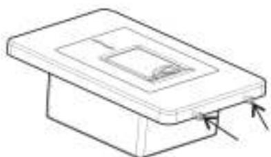
1. Выкрутите два фиксирующих винта.
