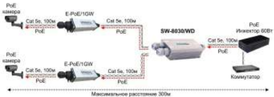
Рис.4 Схема подключения коммутатора/удлинителя SW-8030/WD вместе с удлинителем E-PoE/1GW (приобретается отдельно)
