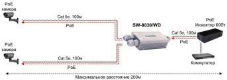
Рис.3 Типовая схема подключения коммутатора/удлинителя SW-8030/WD
