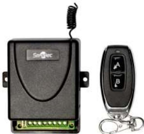
Комплект управления по радиоканалу состоит из приемника и передатчика-брелока и предназначен для дистанционного управления какими-либо устройствами. Данный комплект может использоваться в системе контроля доступа для передачи по радиоканалу команд на открывание дверей, находящихся под управлением СКУД, вместо или дополнительно к кнопке выхода. Также с помощью ST-EX102RF можно управлять любыми исполнительными устройствами: турникетами, замками, освещением и т.д.
