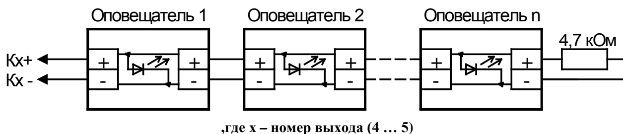
Рисунок 4.2.2 Схема подключения нескольких полярных оповещателей (исполнительных устройств) к одному выходу блока
