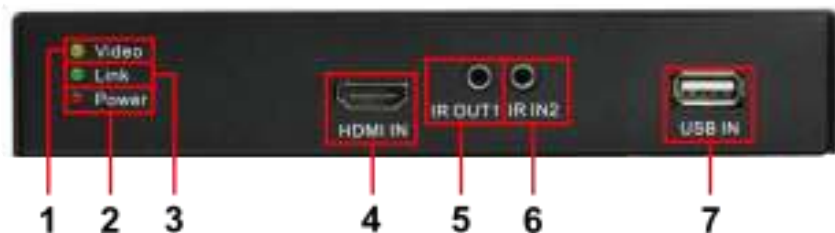
Рис. 2 Передатчик TA-NiKM, разъемы и индикаторы на передней панели
