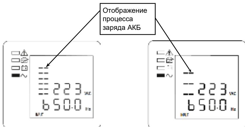
Рисунок 21 — ЖК-дисплей: форсированный (ускоренный) заряд АКБ
