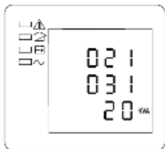
Рисунок 19 — ЖК-дисплей: версия программного обеспечения и модель
