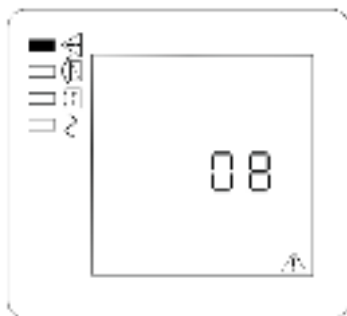
Рисунок 26 – Пример отображения кода неисправности на ЖК-дисплее
