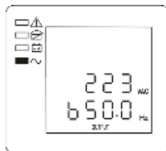
Рисунок 12 — ЖК-дисплей: фаза В, выходное напряжение и частота
