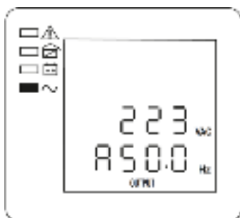
Рисунок 11 — ЖК-дисплей: фаза А, выходное напряжение и частота
