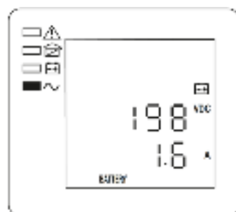
Рисунок 8 — ЖК-дисплей: положительная группа АКБ, напряжение и ток
