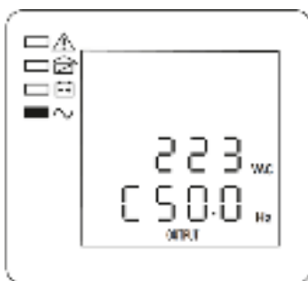
Рисунок 13 — ЖК-дисплей: фаза С, выходное напряжение и частота
