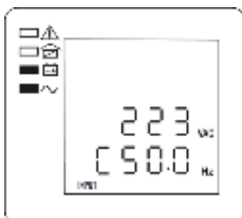
Рисунок 7 — ЖК-дисплей: фаза С, входное напряжение и частота
