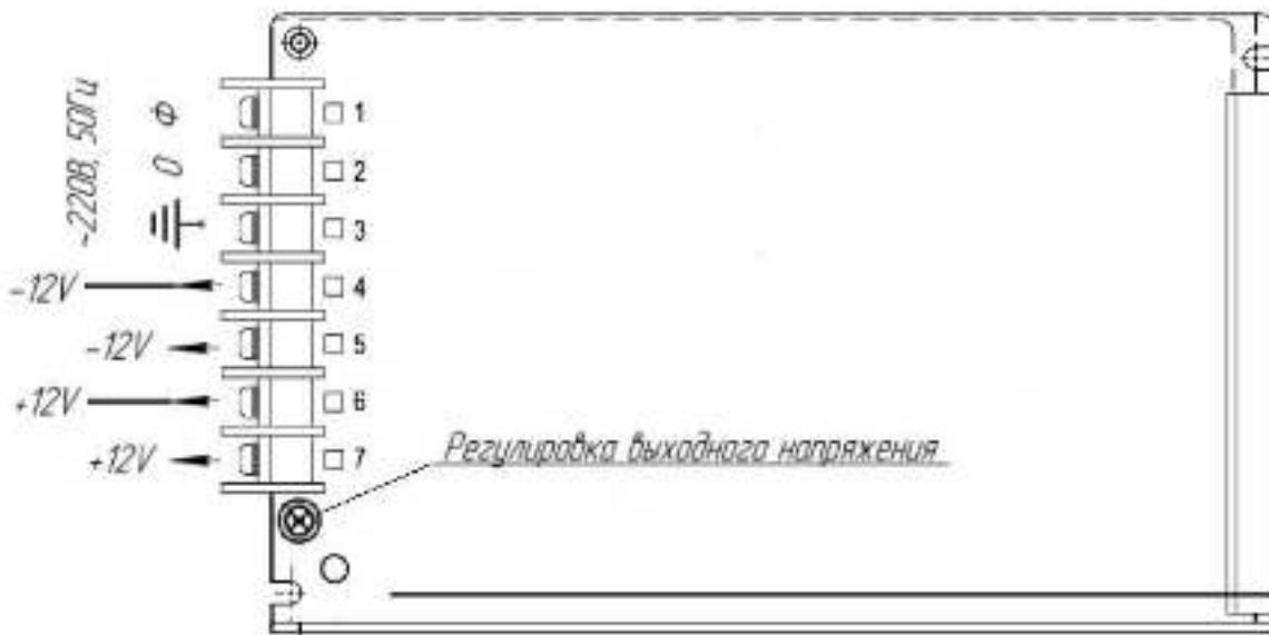
**Внимание!** Несоблюдение полярности подключения может привести к выходу из строя подключаемых устройств.
